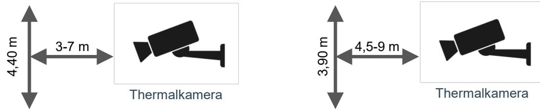
**Abdeckungsbereich der Wärmebildkamera (Länge x Breite) max. Abdeckung**
