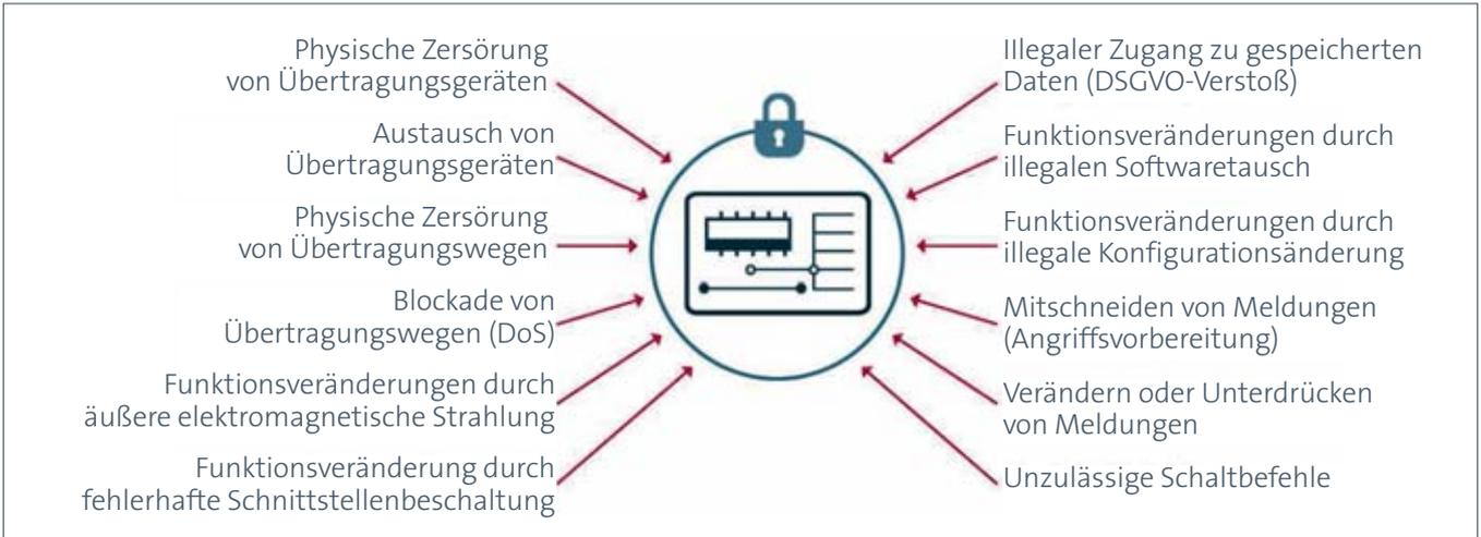
**Bild 1:** Sicherheitsrouter müssen gegen viele verschiedene Einflüsse geschützt sein
