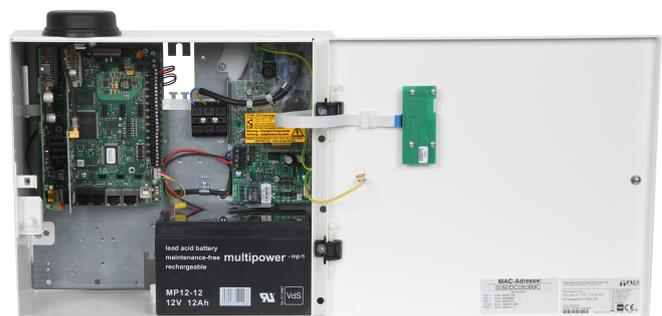
Abb. TAS-Link IV im Gehäuse G4+
